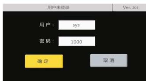
普通登录界面用于用户登录，解锁相关的操作权限，普通用户的操作权限有设备管理、时间设置。默认用户名为：**sys** 默认密码为：**1000**。设定方式为：按“Tab”键将光标指向密码区域，按上下键设置密码，再按“Tab”键将光标指向“确定”，按“OK”键确认。
