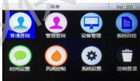
光标选择：在主菜单界面下，按上▲、下▼、左◀、右▶ 方向键，选择功能图标，当图标底色为蓝色的时候，表示选中此功能，按下“OK”键进入相关的界面。
