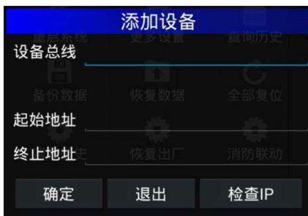
操作：第一步在“设备总线”添加控制器编号（例如1号控制器就填写“1”）；第二步在“起始地址”添加探测器第一个地址；第三步在“终止地址”添加探测器最后一个地址，第四步按下确定键即可添加成功。
