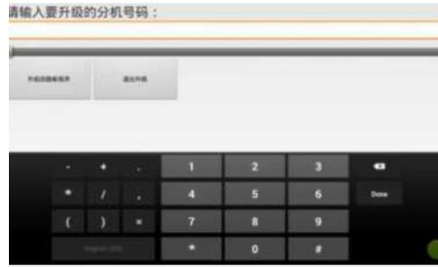
操作：轻按“程序升级”图标，弹出程序升级功能界面，输入所需要更新的通讯板回路号，按下“升级回路板程序”键对通讯板程序进行更新。
