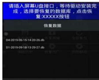
操作：在显示屏背面上端 USB 口处插入空白 U 盘，轻按“恢复数据”图标，弹出提示
