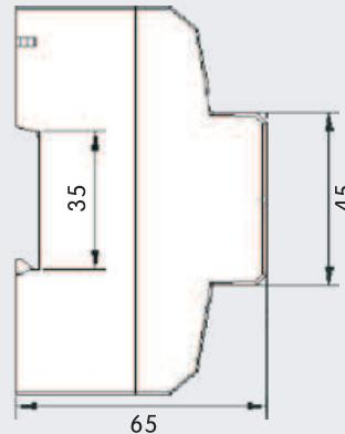
产品外形尺寸: 100 × 76 × 65mm 安装方式: 导轨式安装
