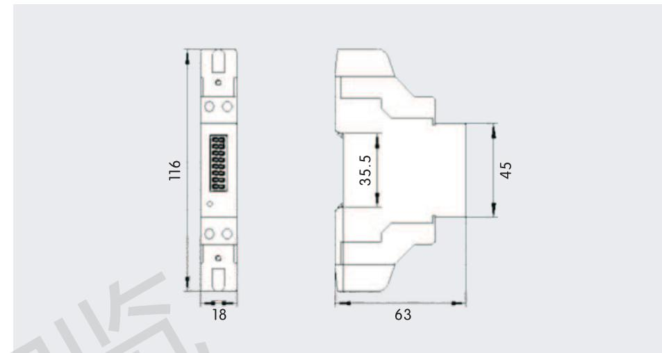
产品外形尺寸: 116×18×63mm 安装方式: 导轨式安装
